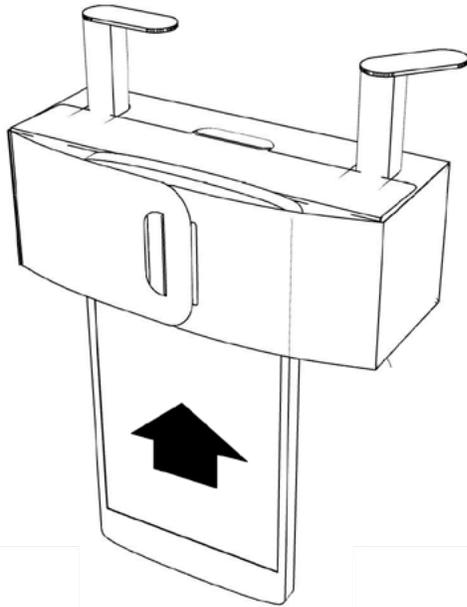
9. Inserta tu celular de abajo hacia arriba con la linterna encendida, entre las abrazaderas hasta que la luz se alinee con la rendija de la caja.
