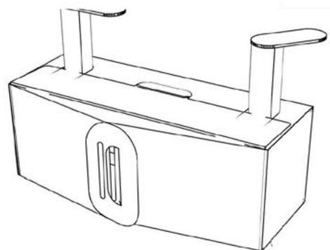
8. Cierra la caja, fija y ajusta las abrazaderas que atraparan el celular que vas a usar. Usa la ranura de las abrazaderas que se adecue al tamaño de tu celular para que quede ajustado.
